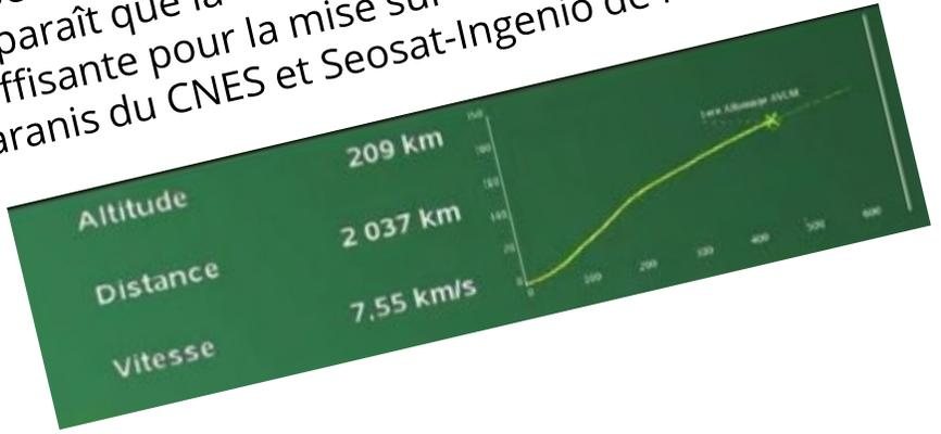
**La commission d'enquête confirme que la défaillance est due à un câblage et une connexion incorrects des actionneurs électromécaniques du système de contrôle de vecteur de poussée de l'étage supérieur AVUM, entraînant une inversion des commandes de direction qui a conduit à la dégradation de la trajectoire et la perte du véhicule.**
