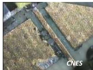
corrosion de carte électronique due à une contamination ionique
