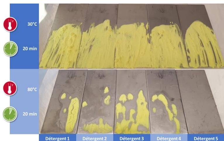
Figure 3: Exemple de résultat d'essais de détergence
