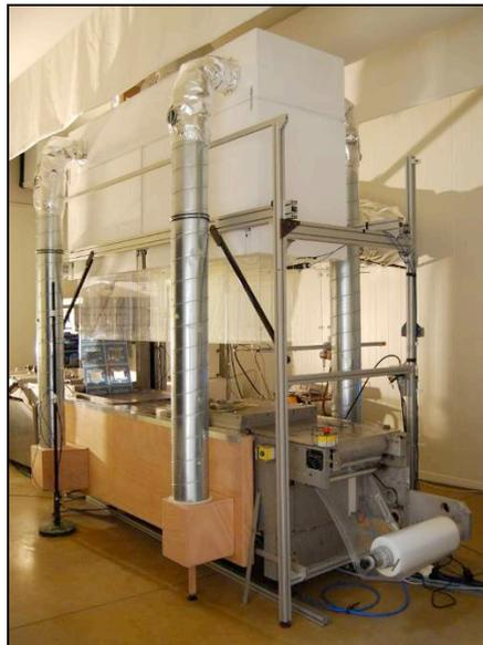
Figure 4 - Thermoformeuse équipée du système de protection localisée Froiloc®
