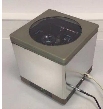
**Figure 1. CLEAPART-100 pour le suivi in situ et temps réel des particules déposées en salles propres**
