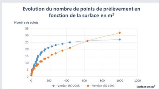
Fig. 1 : Comparaison entre le nombre de points de prélèvement d'air selon ISO 14644-1 (1999) et ISO 14644-1 (2015)
